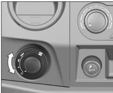
Управление дополнительным отопителем осуществляется ручкой, расположенной на панели приборов, с помощью которой регулируется скорость работы вентилятора (от 1 до 3).
