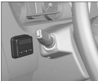
Управление независимым отопителем осуществляется пультом, расположенными на панели приборов.
