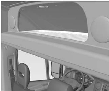
На автомобилях с цельнометаллическим кузовом над водителем предусмотрена полка для багажа.
