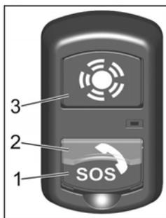
**Кнопка 1 экстренного вызова SOS предназначена для использования в случае ДТП или при других чрезвычайных ситуациях.**
