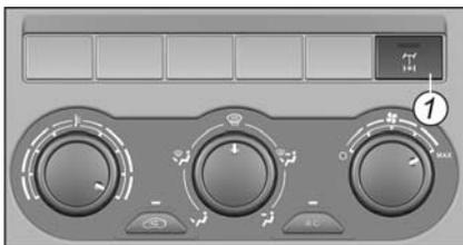
В случаях, когда необходимо преодолеть трудный участок дороги, блокировка дифференциала позволяет водителю жестко соединить оба задних колеса и передать на них весь крутящий момент. Включение блокировки дифференциала осуществляется выключателем 1 на панели приборов.
