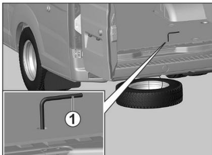
На отдельных комплектациях автомобилей с цельнометаллическим кузовом для снятия запасного колеса предусмотрен специальный Г-образный ключ 1, расположенный во вкладыше комплекта инструмента.
