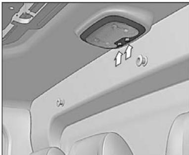
На автомобилях с платформой и двухрядной кабиной плафон внутреннего освещения второго ряда сидений расположен на обивке крыши в средней части. Плафон имеет две кнопки и две секции освещения второго ряда сидений.
