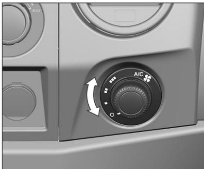
Управление задним кондиционером осуществляется ручкой, расположенной на панели приборов, с помощью которой кондиционер включается и обеспечивается переключение скоростей работы вентиляторов (от 1 до 3). Охлажденный воздух подается в салон через щелевидные
