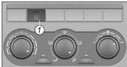
Догреватель включается кнопкой 1 при работающем двигателе и включенном отопителе. Далее догреватель работает в автоматическом режиме, повышая температуру теплоносителя, поступающего в систему отопления до 80-85°C,
