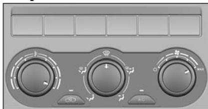
Для быстрого устранения запотевания ветрового стекла и стекол дверей, установите ручки 1 и 3 на пульте управления в крайнее правое положение, а ручку 2 в положение
