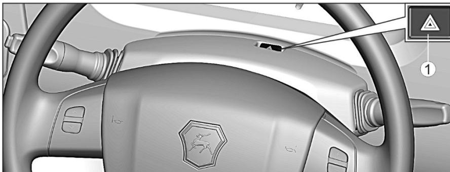
Выключатель 1 расположен в окне верхнего кожуха рулевой колонки.
